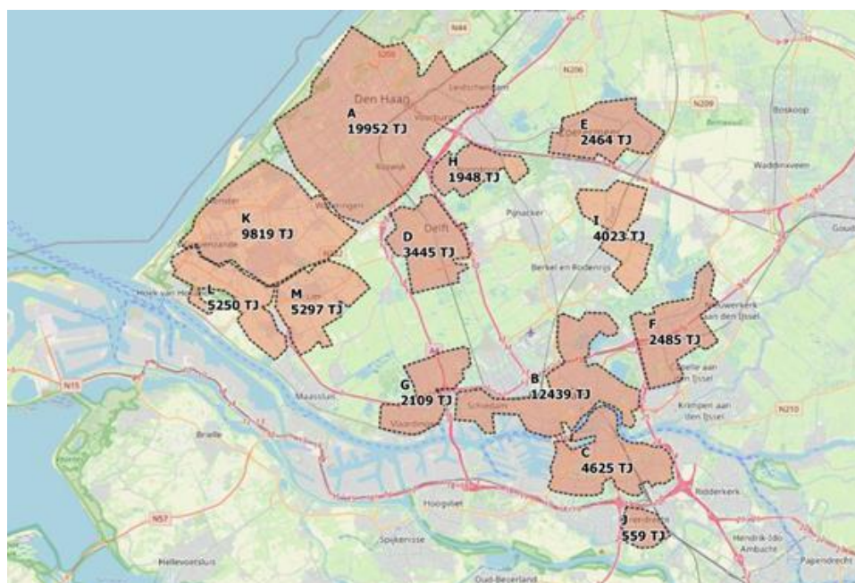
Figuur 5.3 Inrichting warmteclusters Samenland en Kralenlandscenario. Bestaat uit 13 clusters met een warmtevraag van 0,5 PJ tot ruim 19 PJ. Omvang warmtevraag 74 PJ in 2020. Grote warmteclusters zoals Den Haag (A), Westland (K/L/M), Rotterdam (B) en Oostland (I) dragen de ontwikkeling van het warmte-uitwisselingsscenario en maken de ontwikkeling van backbones mogelijk. Naast benutting van lokale bronnen wordt restwarmte aangevoerd vanuit HIC Rotterdam.
